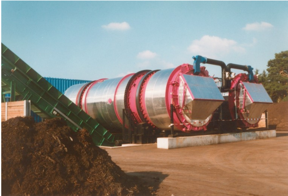
Fig. 5.20 Decomposition Drum System Envital (Plant Ansbach/Bechhofen) (Photo: Envital)
