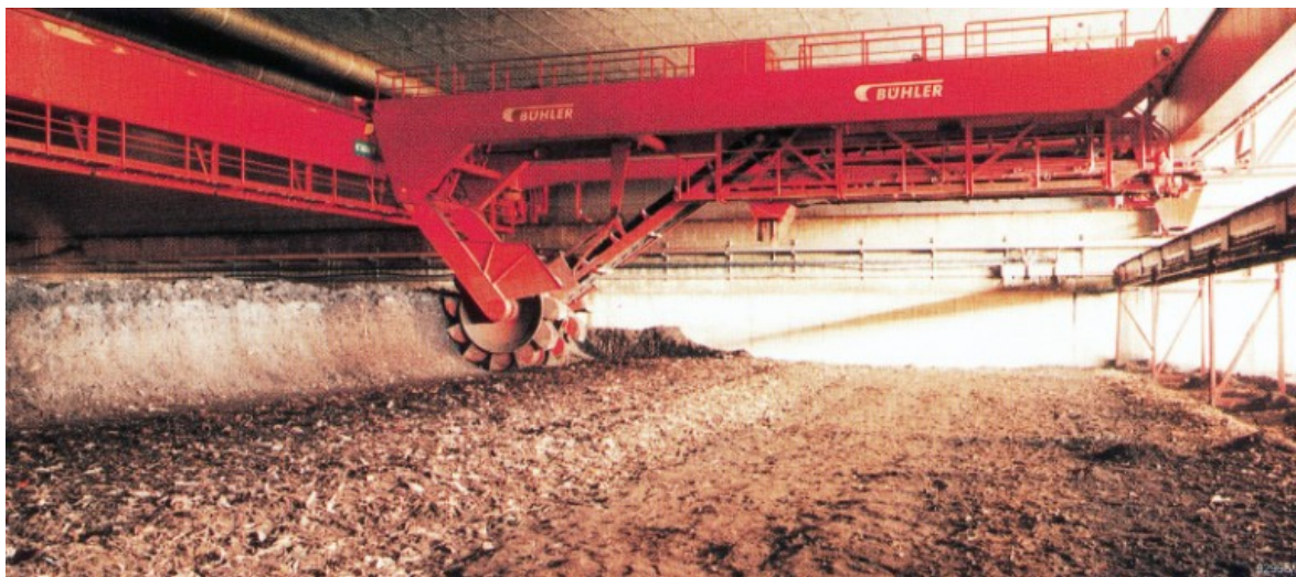
Fig. 5.22: Windrow Composting System Bühler „Wendelin“ (Photo: Bühler)
