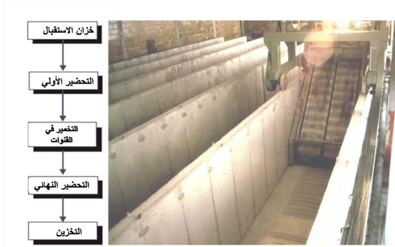
الشكل 8-19- نموذج لنظام القنوات في محطات الأسمدة مع مخطط سير العمليات [6]، [10]
