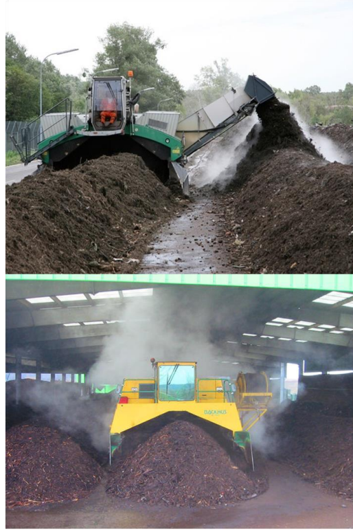
الشكل 8-22 نظام الكومات المصفوفة المهواة طبيعياً المسقوفة والمكشوفة مع نماذج من طرق التهوية والتقليل
