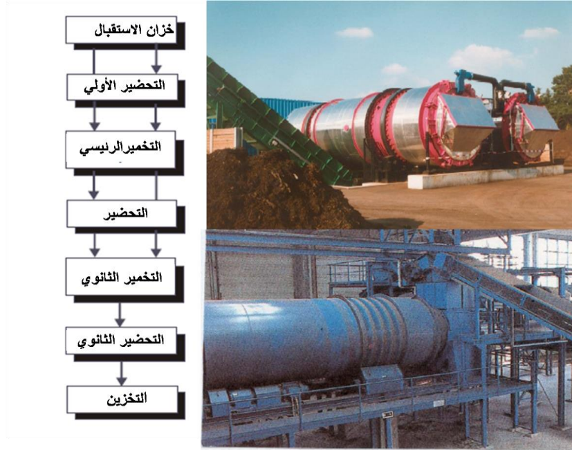
الشكل 8-21- نماذج لنظام اسطوانات التخمير مع مخطط سير العمليات
