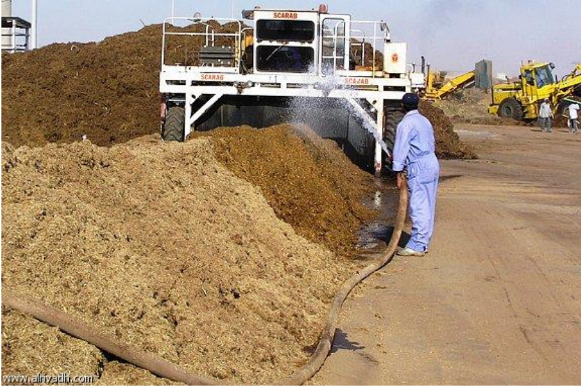
شكل (٢-١٨) آلة فرم السماد العضوي الذاتية الحركة
