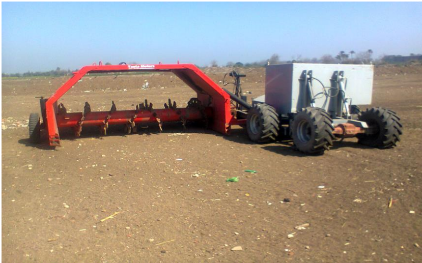
شكل (٢-١٨) آلة فرم السماد العضوي الذاتية الحركة
